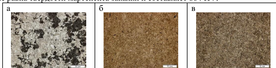
Рис. 3. Структура стали R350LHT после непрерывного охлаждения со скоростями 10\text{ }^{\circ}\text{C}/\text{с} (а), 30\text{ }^{\circ}\text{C}/\text{с} (б), 100\text{ }^{\circ}\text{C}/\text{с} (в)
