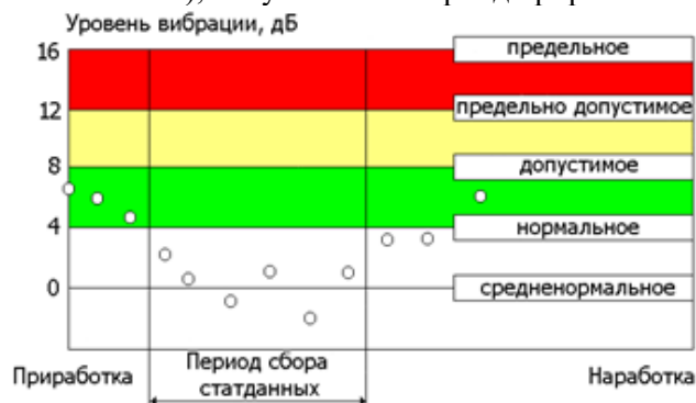
Рис. 2. Схема сбора данных для расчета средненормального уровня вибрации и критериев определения различных состояний
