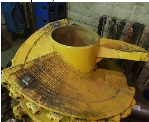
Рис. 2. Защитные пластины на шнеке комбайна JOY 4LS20
