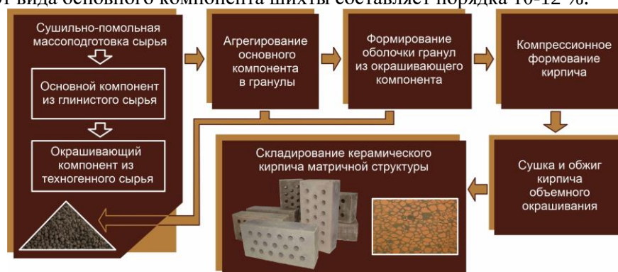
Рис. 1. Общие технологические принципы получения декоративного кирпича с матричной структурой
