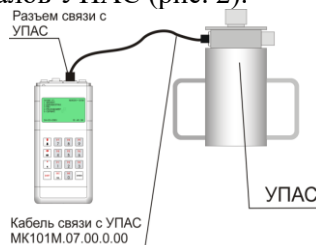
Рис. 2. Комплект оборудования для проведения измерений протяженности дегазационных скважин в шахтных условиях
