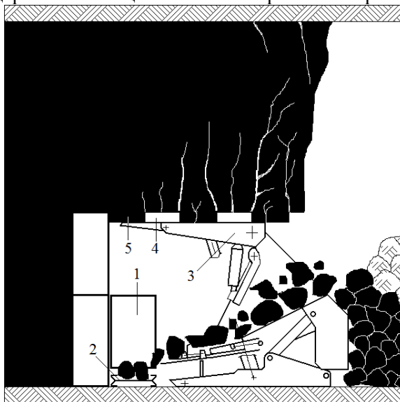
1 – очистной комбайн; 2 – забойный скребковый конвейер; 3 – секция механизированной крепи поддерживающе-оградительного типа; 4 – каналы; 5 – целики угля
